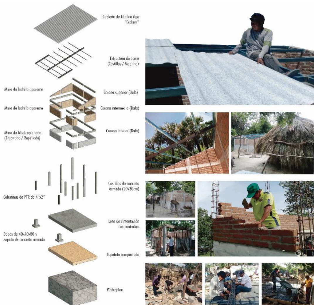
Imágenes 21. Elementos constructivos de la vivienda sismo resistente, tipo ikoots + mol. Gráfico y fotografías: Reconstrucción.istmo ITESO
