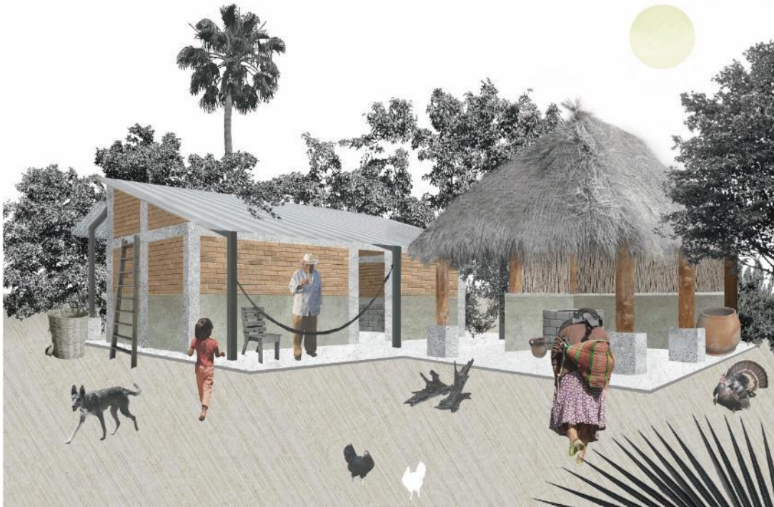
Imagen 23. Vista exterior de la vivienda sismo resistente, tipo ikoots + mol. Dormitorio de tabique de barro cocido y concreto armado y cocina tradicional de madera y palma. Gráfico: Reconstrucción.istmo ITESO
