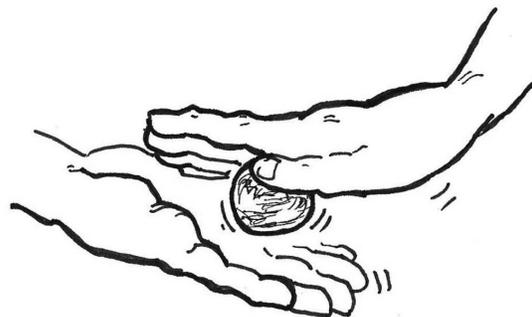
Déjela secar por 24 horas, luego apriétela con los dedos pulgar e índice de una mano. Si la bolita no se rompe, la tierra es adecuada. Si se rompe, el suelo no tiene suficiente barro, por lo que no se puede utilizar.
