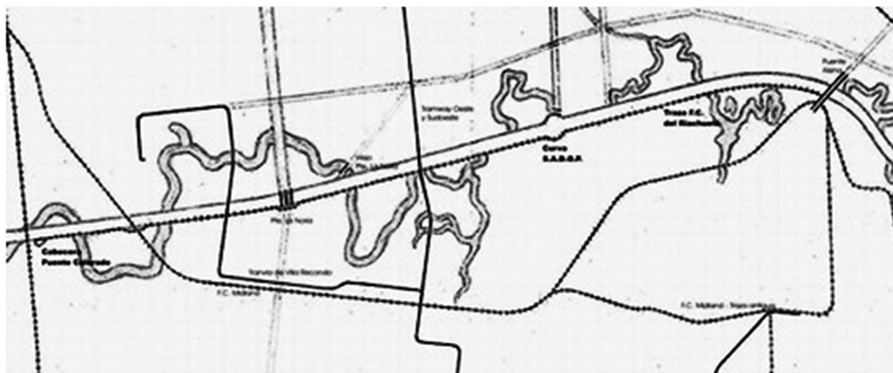
Figura 6. Superposición traza original del Riachuelo y proyecto de rectificación.
