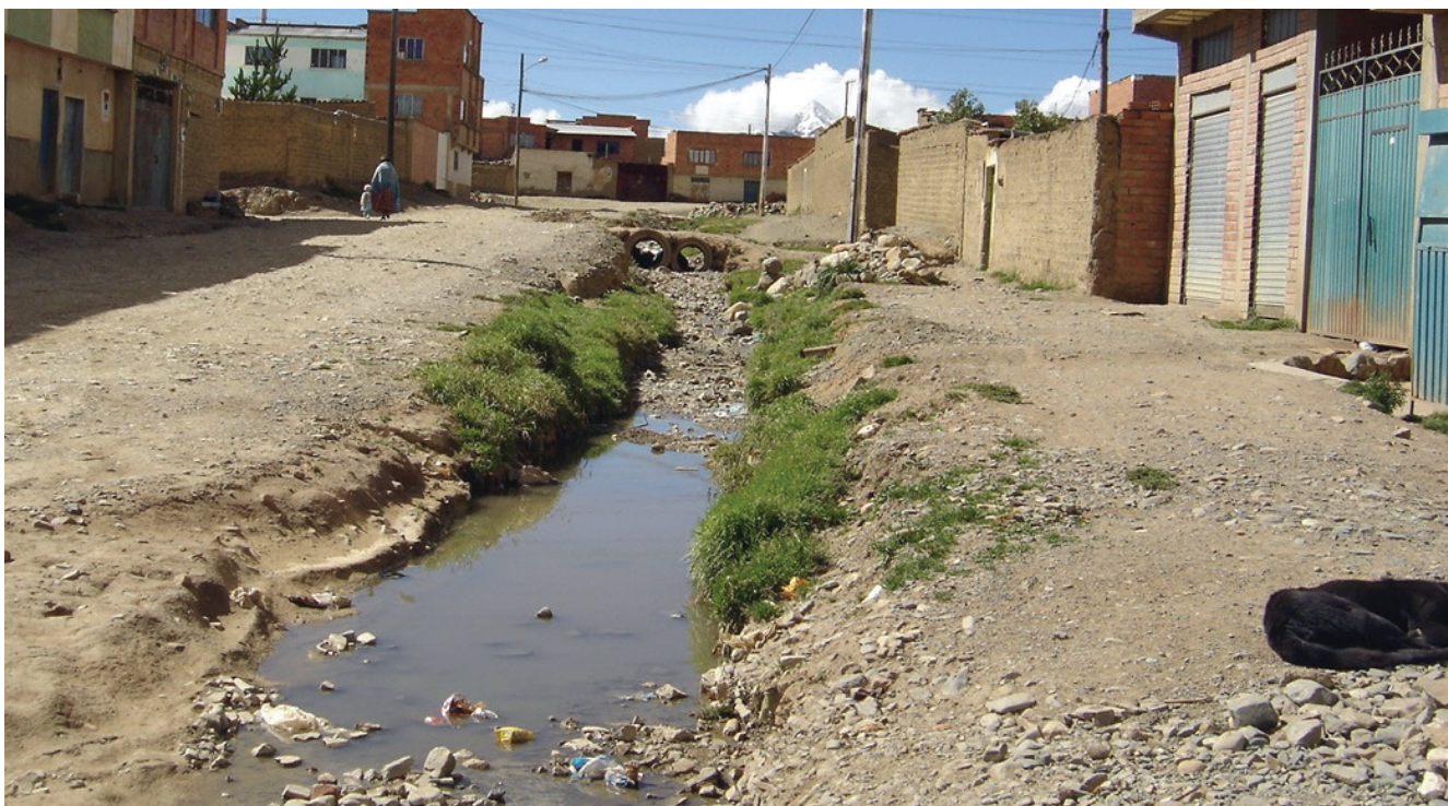
Conformación de charcos de aguas servidas en las calles por la falta de alcantarillado sanitario (Archivo fotográfico RED HÁBITAT)
